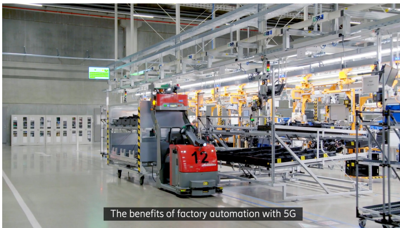
图 17 5G 毫米波支持 AGV 运行
